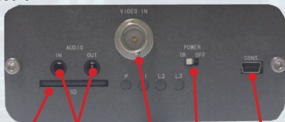
音声入出力 SDカード ビデオ入力 電源スイッチ コンソール
