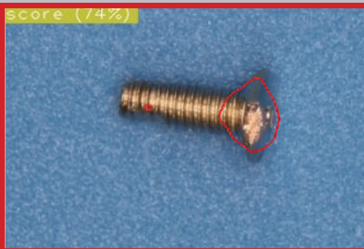
異常画像（欠陥あり）
