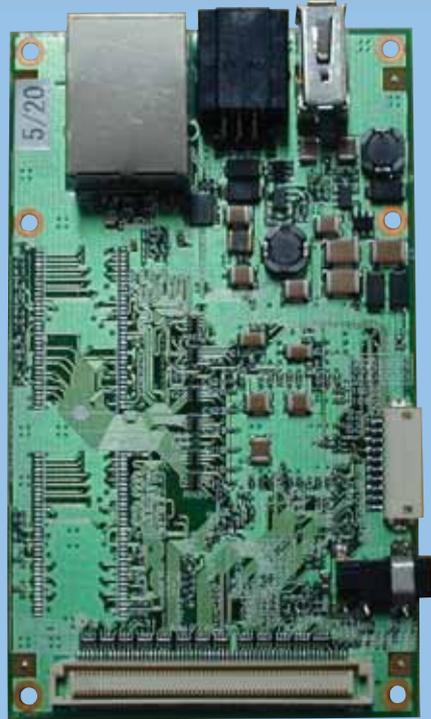
PowerPC MPC5200/400MHzの高速CPUと、128MB RAMを搭載したCPUボード。OSはNetBSDを採用し、カーネルをFlashROMに実装。拡張バスコネクタを装備しており、H/Wの開発基板として使用可能です。オリジナル基板設計時のベース基板としてご活用頂けます。
